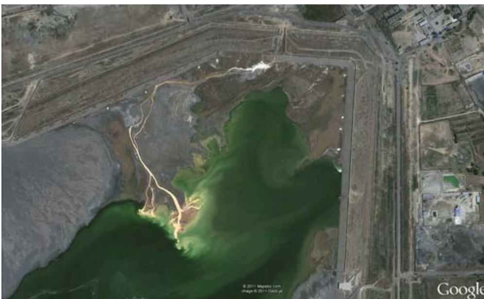
Noordelijke detailopname van het gifmeer bij Baotou. Duidelijk zijn de tientallen lozingspijpen te zien die per dag meer dan 100.000 liter zwaar verontreinigde grond met giftige vloeistoffen in het meer lozen.
